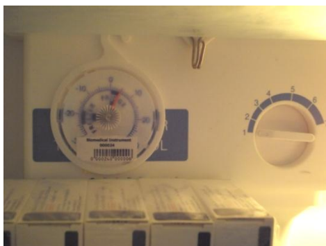
รูปที่ 9 เทอร์มิเตอร์สำหรับวัดอุณหภูมิตู้เย็น
